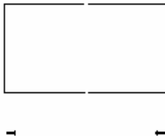
Linee di misura su elementi interrotti
